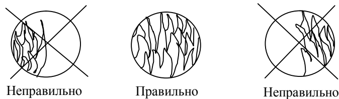
Рис. 10. Расположение датчика относительно пламени и вид на пламя через визирную трубу.
